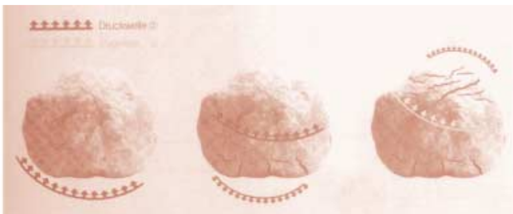
Σχηματική παράσταση διάσπασης λίθου με ωστικά κύματα 1. κύριο ωστικό κύμα και 2. ανακλαστικό ωστικό κύμα.
