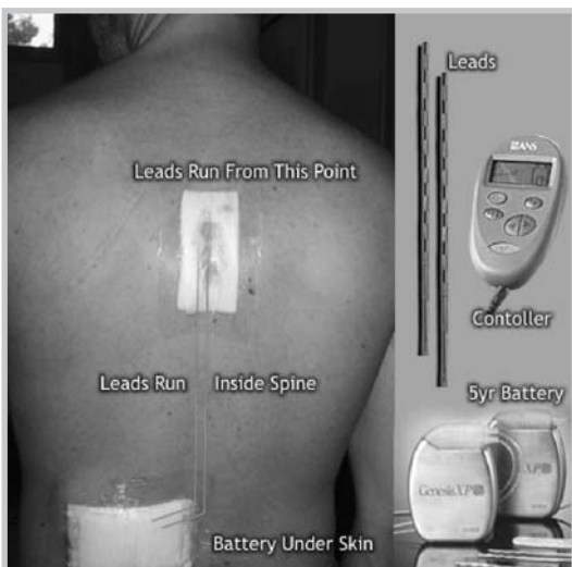
4. Σύστημα ηλεκτρικής διέγερσης νωτιαίου μυελού και εικόνες τοποθέτησής του σε ασθενή
